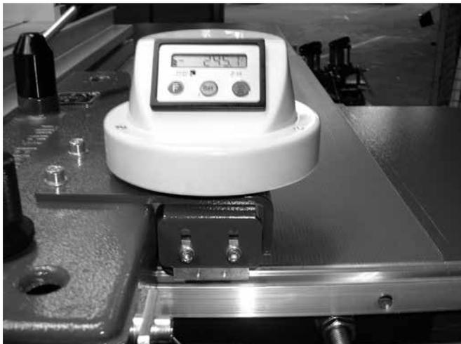
De sensor moet zich juist in het midden boven de magneetstrip bevinden, en moet ingesteld worden op een hoogte van 0,5 mm maximaal boven de magneetstrip.
