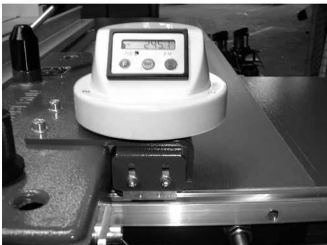
Lors du montage veillez à ce que le capteur se trouve au milieu de la bande magnétique et se trouve entre 0,5 mm maximal au dessus de la bande. Assurez vous que cette distance de 0,5 mm soit respectée sur toute la longueur de la bande magnétique.
