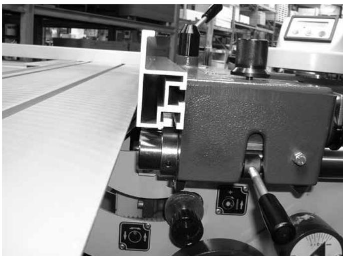
La rallonge de table fourni vous permet, comme il était le cas avant, de couper jusqu'à 1380 mm, et sert en même temps de protection de la bande magnétique.
