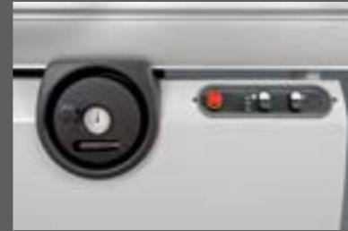
Bedieningspaneel Z400 met analoge uitlezing van de helling van het zaagblad.
